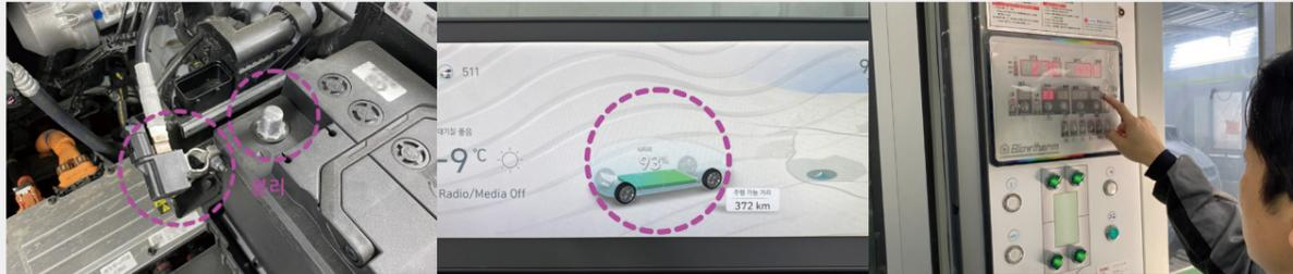
배터리 비활성화 및 배터리 온도 30도 이하      배터리 충전 상태 45% 이상      60도 넘지 않는 온도에서 30분 이하 건조
